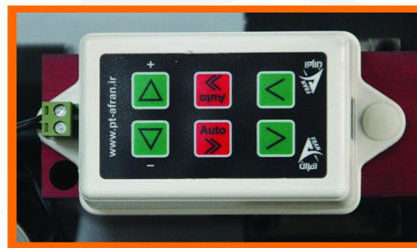
۱/۱۲) دو تا کلید مثبت و منفی جهت تنظیم دور تراش می باشد. شما در حین حرکت می توانید دور تراش دستگاه را تنظیم نمایید. در جاهایی که حجم باربرداری زیاد است دور تراش را کم می نمایید. لازم به ذکر است که شما همیشه باید با دور تراش بالا بتراشید.
